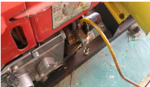
Gambar 4. Pengujian Vibrasi pada Base Mesin
