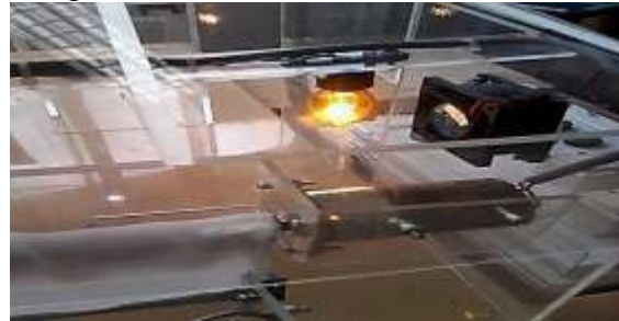
Gambar 8 Lampu Dan Kipas Saat Menyala Pada Kamar Tidur, Jika Ada Gerakan Dari Sensor Pir.
