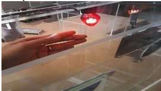
Gambar 7 Lampu Dan Kipas Menyala Pada Ruang Tamu, Jika Ada Gerakan dari Sensor Pir.
