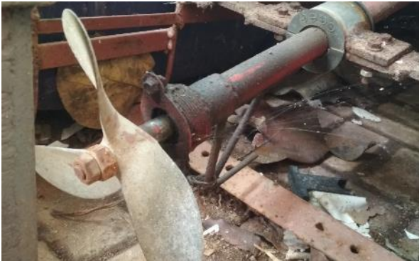
Gambar 1. Bagian aus pada poros propeller
