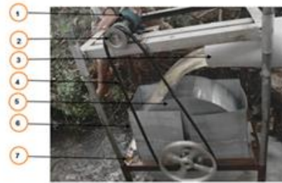
Keterangan : 1. Generator 5. Turbin Crossflow 2. Pulley 6. Rumah Turbin 3. Pengarah Air 7. Rangka 4. Sabuk-V
