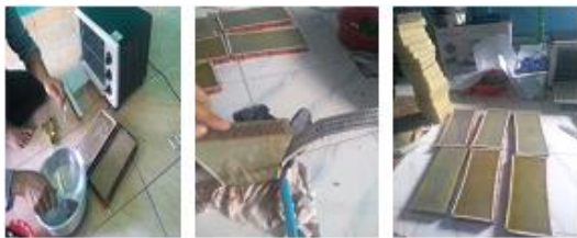
Gambar 2. Material komposit berpenguat serat daun nanas dari hasil pencetakan
