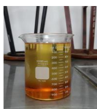
Gambar 3. Proses Pemisahan Gliserol dan Biodiesel
