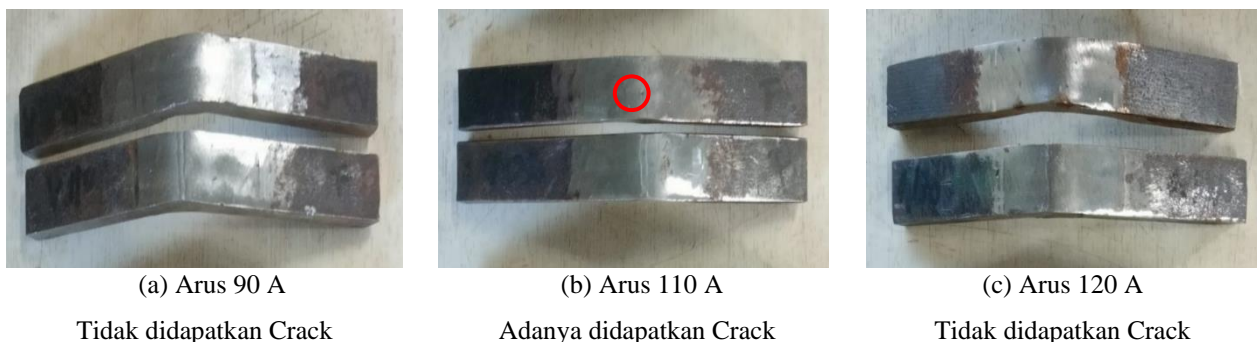
Gambar 10. Spesimen Hasil Uji Bending Kampuh V
