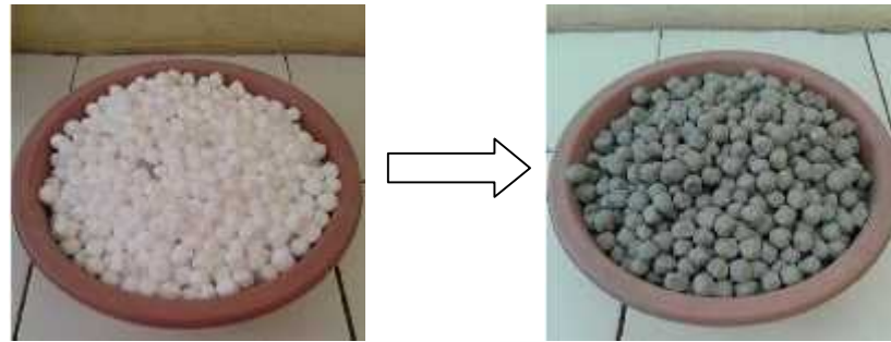
Gambar 4. Butiran agregat kasar styrofoam.
