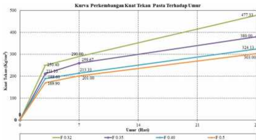
Gambar 3. Kurva perkembangan pengujian kekuatan tekan pasta
