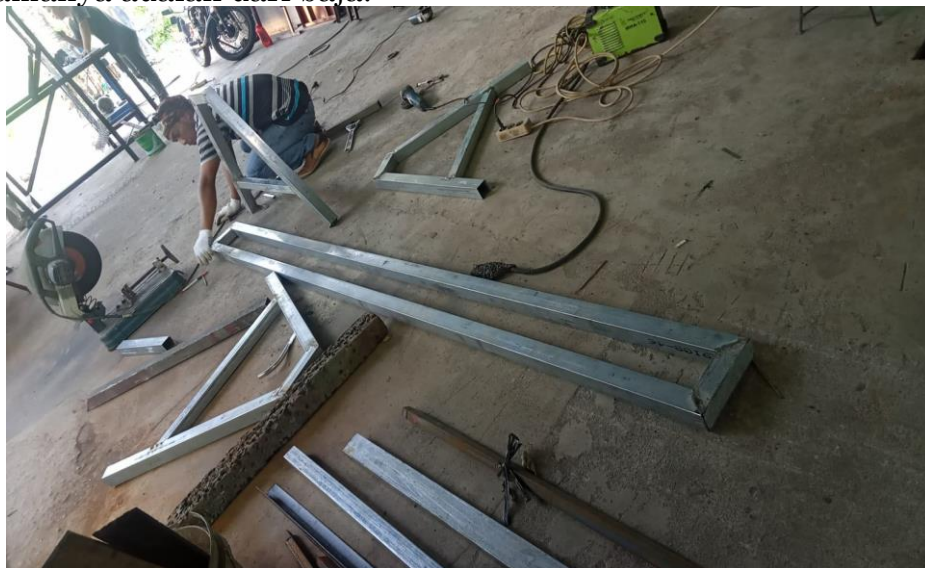
Gambar 8. Pembuatan Meja Sablon di Tempat Pengelasan (Zulkarnain & Junaidi, 2021)
