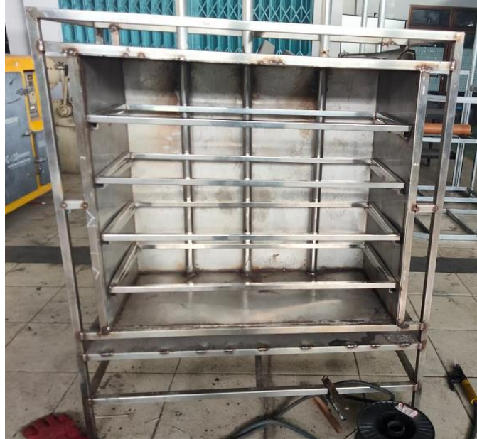
Gambar 5. Konstruksi rangka oven pengering ikan tampak depan
