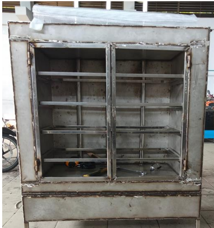
Gambar 7. Pemasangan pintu oven pengering ikan
